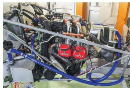
An den Rotax ist ein Generator gekoppelt, der elektrische Energie für den Reiseflug liefert.
