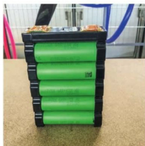
600 dieser Batteriepakete bilden den Akku. Aus der FormulaE: 3000 Batteriezellen speichern die elektrische Energie.
