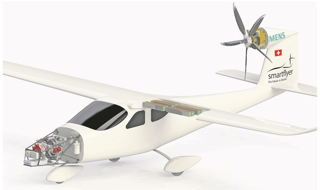
An der Modellzeichnung ist der Antriebsstrang zu erkennen: Vorne im Bug der Generator, die Batteriepakete im Flügel und der Elektromotor am Seitensteuer.
